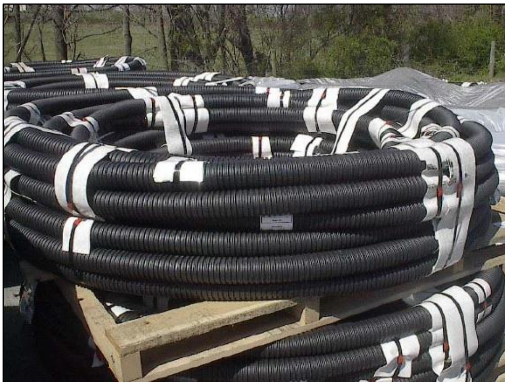
شکل ۱۳: تاندون‌های کابلی آماده شده
