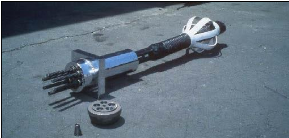
شکل ۱۰: سترلایزر نشب شده بر روی یک تاندون کابلی
